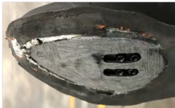
ABBILDUNG 22 – SCHLEIFEN DER PLATTE, WOBEI AUF DIE KONVEXE BAUWEISE DES BEREICHS ZU ACHTEN IST
