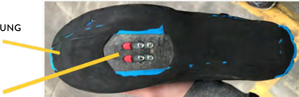
ABBILDUNG 15 – DURCH OPTIMALES SCHLEIFUNG WERDEN ZWEI MATERIALIEN FREIGELEGT: GUMMI UND KUNSTSTOFFPLATTE
