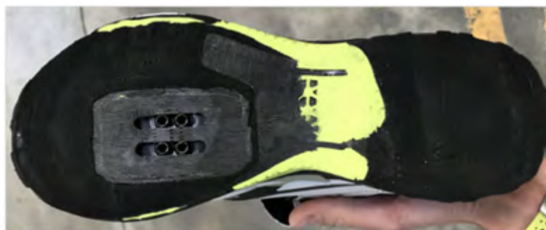
ABBILDUNG 25 – VORBEREITUNG DER UNTERLAGE DES SCHUHS MIT GUMMI, EVA UND KUNSTSTOFFPLATTE
