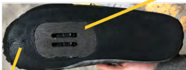
ABBILDUNG 9 - ABBILDUNG 9 – OPTIMALES SCHLEIFUNG MIT FREILIEGENDEM EVA
