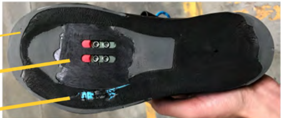
ABBILDUNG 13 – SCHLEIFEN DES BALLENS, UM KUNSTSTOFFPLATTE, EVA UND GUMMI FREIZULEGEN
