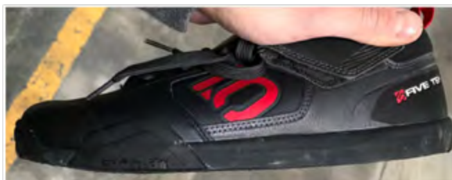
ABBILDUNG 10 – ÜBERMÄSSIGES SCHLEIFUNG AN DER FERSE. DAS IDEALE PROFIL SOLL DEN ORIGINAL-DROP DES SCHUHS MÖGLICHST BEIBEHALTEN
