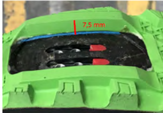
ABBILDUNG 2 - OPTIMALER ABSTAND ZWISCHEN DER STOLLENBERSEITE UND DEM BODEN, AUF DEM DIE NOPPE AUFLIEGT
