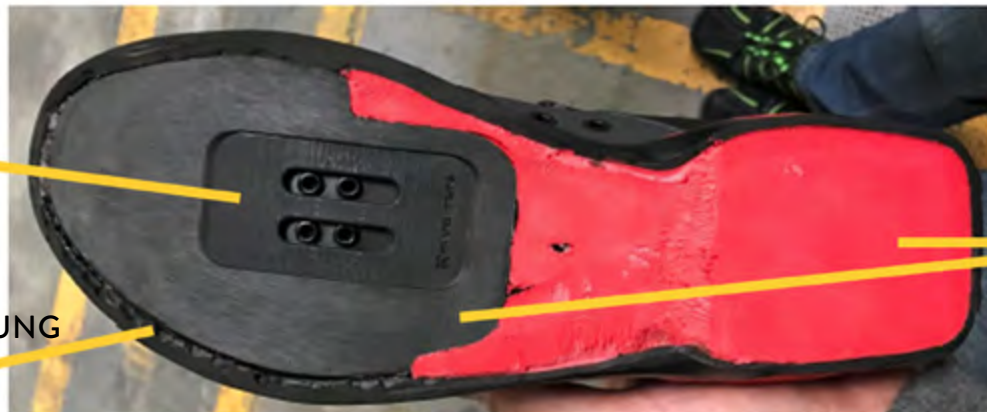
ABBILDUNG 6 – BALLEN MIT VERBLEIBENDEN GUMMIRAND
