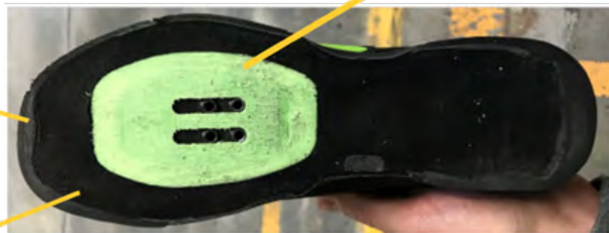
ABBILDUNG 18 – OPTIMALES SCHLEIFUNG MIT TEILEN AUS EVA, GUMMI UND KUNSTSTOFF
