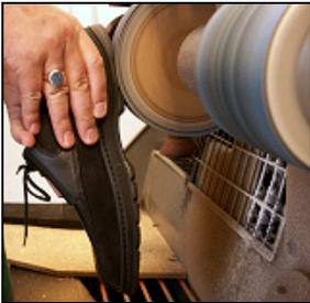
Entfernen der Laufsohle und Anzeichnen einer „Arbeitslinie“.
