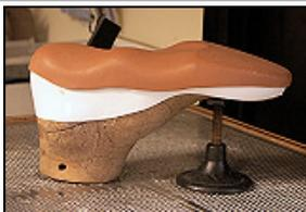
Der **Platzhalter** wird auf das Maß der späteren Einlage zugeschnitten. Beim Tiefziehvorgang wird diese Kontur auf die Materialien übertragen. Anhand dieser Kontur lässt sich der Rand der Einlage einfacher beschneiden.
