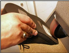
Ausschleifen des Original-PU-Bodens bis auf die Decksohle im Vorfuß (sehr dünn ausschleifen).
