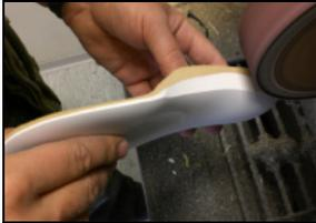
Einlage auf der Unterseite und seitlich in Form schleifen. Bedingt durch die Keilform im Vorfuß wird der Schleifaufwand minimiert.
