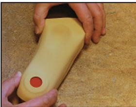
Ablüften lassen und **Supersorb** einlegen (nicht verkleben, damit die Funktion erhalten bleibt) und die bereits vorgeformte **nora® Lunacell** Schale aufkleben.
