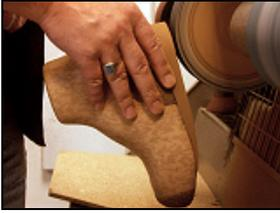
Ablüften lassen und anschließend in Form schleifen sowie Aufräuen der Laufsohle nora® Astro Soft Profil 96.
