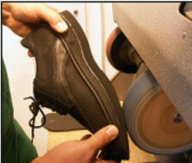
Beschleifen und Einschleifen der Ballenrolle.
