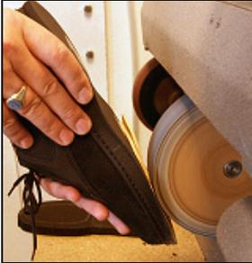
Formschleifen der beiden verklebten Schichten.
