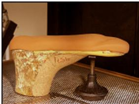
Als **Platzhalter** für die später einzusetzende Decke empfiehlt sich der Einsatz von **nora® Norit**. Der Platzhalter wird direkt auf dem Leisten angeformt und verbleibt während der Verarbeitung weiterer Materialien auf dem Leisten (nicht verkleben). Zusätzlicher Nutzen: Durch die glatte Oberfläche von **nora® Norit** werden Unebenheiten des Leistens kaschiert.
