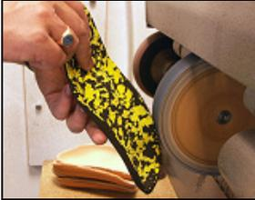
Formschleifen und den Fersenbereich Planschleifen.
