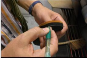
Einlage auf der Unterseite und seitlich in Form schleifen.
