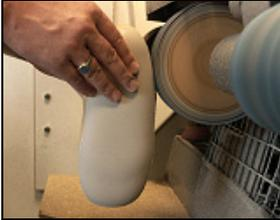
Formschleifen an der Schleifmaschine.
