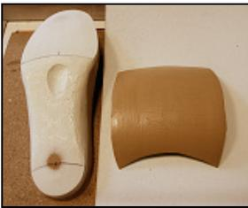
Einstreichen und kurzes Aktivieren (maximal ca. 1 Minute) von **nora**<sup>®</sup> Lunacell zur Stabilisierung.
