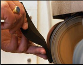
Formschleifen an der Schleifmaschine.
