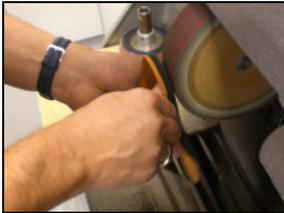
**nora® Lunatec combi 6** auf der Unterseite einschleifen, um **nora® Supersorb** zu integrieren.
