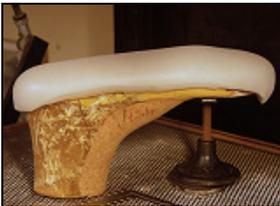
Anformung von nora® Lunatec combi 3 auf dem Leisten im Vakuumtherm.
