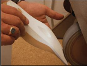
Formschleifen an der Schleifmaschine.
