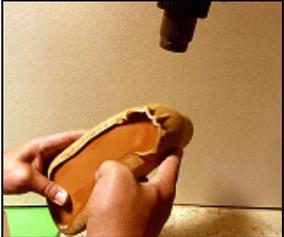
**Tipp:** Falten im Fersenbereich lassen sich durch Aktivieren mit dem Heißluftfön optimal entfernen.
