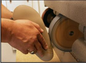
Formschleifen an der Schleifmaschine.
