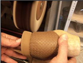
**Tipp:** Durch das **Glattbürsten** mit einer farblosen Rosshaarbürste (ohne Wachsaufrag) wird die Oberfläche von EVA Material deutlich glatter.
