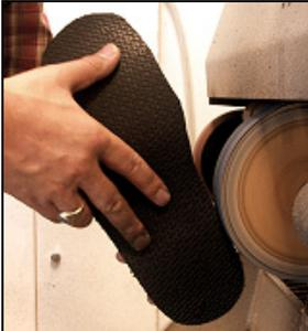
Den fertigen Aufbau beschleifen.
