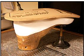
Nach einer Aktivierdauer von 4 Minuten von nora® Lunasoft SLW für 1 weitere Minute nora® Lunacell perforiert dazu legen und nach insgesamt 5 Minuten beide Materialien aus dem Ofen nehmen und in einem Arbeitsgang verkleben und anformen. Abkühlen lassen.
