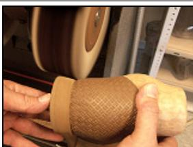
Durch das **Glattbürsten** mit einer farblosen Rosshaarbürste (ohne Wachsaufrag) wird die Oberfläche von EVA Material deutlich glatter.
