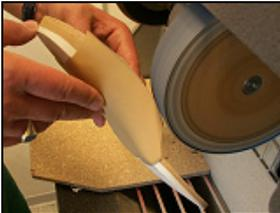
Anpassen der Stabilisierung an die Einlage.
