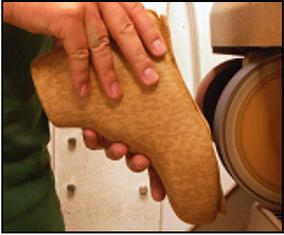
Planschleifen des Zwickeinschlages.
