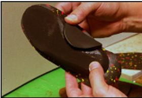
Die Rückseite der Einlage und das Stück **nora® Lunacell** für die Längsgewölbestütze einstreichen und ablüften lassen. **nora® Lunacell** kurz aktivieren (ca. 2 Minuten) und anformen.
