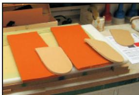
nora® Lunatec SE für die Basis der Einlage und nora® Lunacell als Stabilisierung im Rückfuß zuschneiden.
