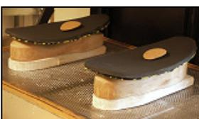
Nach 4 Minuten Aktivierung von Lunasoft SL die Abdeckung aus Lunasoft SL color plus mit in den Ofen legen und beide Materialien nach einer weiteren Minute entnehmen. In **einem Arbeitsgang** verkleben und im Vakuumtherm anformen.
