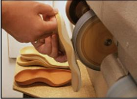
Formschleifen an der Schleifmaschine.
