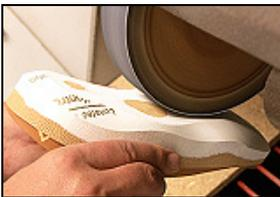
Formschleifen an der Schleifmaschine.
