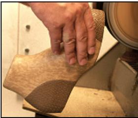
Planschleifen der neu verklebten Bereiche.
