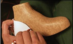
Anzeichnen und anschließendes Aufrauen der Bereiche für die Vorder- und Hinterkappe.
