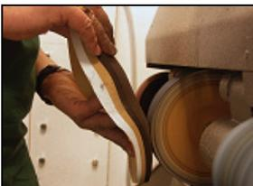
Formschleifen an der Schleifmaschine.
