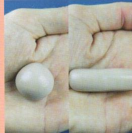
**4.** Aus der gleichmäßig gemischten Silikonmasse ERKOTON wird nun je nach Anwendung eine Kugel oder ein Strang geformt, um beim Anformen Luft einschüsse und Falten zu vermeiden.
