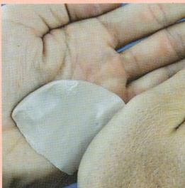
**3.** Nachdem ERKOTON grob vermischt ist, wird die Masse zwischen den Händen ausgestrichen, bis eine gleichmäßige Farbe erreicht wird. Das Mischen von ERKOTON sollte nach 30 Sek. abgeschlossen sein.
