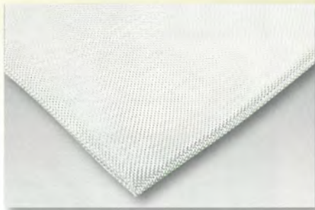
Glasseidengewebe, 100 x 100 cm für harte Lamine aus Polyester-, Acryl-, Epoxidharz, 390 g/m 2 , Stärke: ca. 0,4 mm
