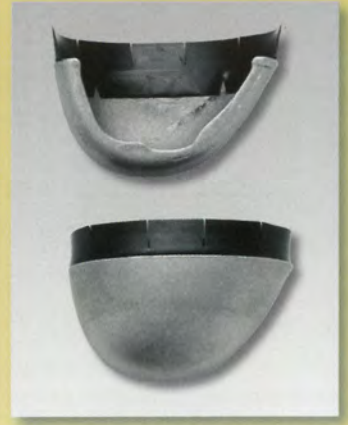
Alukappen Art. 522 normale Form, Größen: 8, 9, 10, 11 Breiten: 86,8–96 mm Höhen: 42,4–47,6 nach EN 12568
